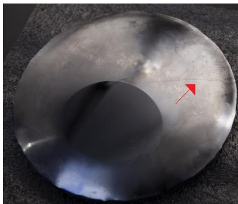
图 1 裂纹（强光手电光照，肉眼观察）
