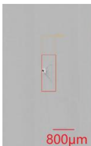
图 91a) 三角形缺陷引起外延层基平面位错 (明场表面图像, 微分干涉法)
