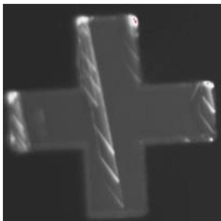
图 103c) 源于台面侧壁的缺陷传播 (p+nn+二极管, 30 min)
