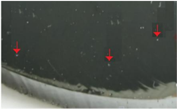
图 7 晶锭微管（强光手电光照，肉眼观察）
