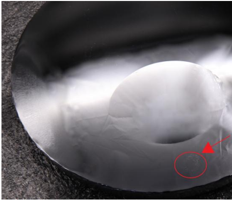
图 8 晶锭微管聚集区（强光手电光照，肉眼观察）
