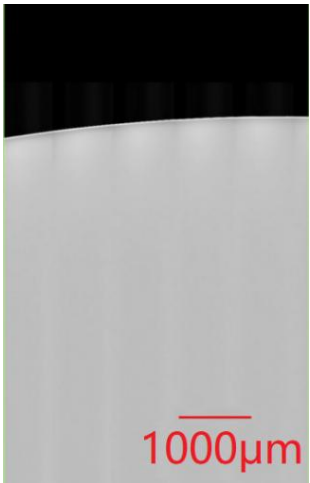
图 93a) 晶片边缘应力引起外延层基平面位错 (明场表面图像, 微分干涉法)
