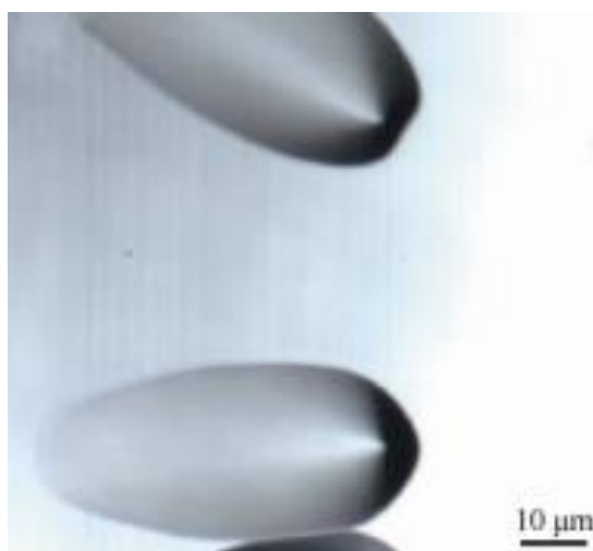
图 2.11 BPD 的腐蚀形貌
