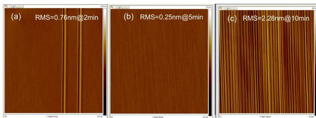
图 3.16 不同刻蚀时间下样品表面的 AFM 图像
